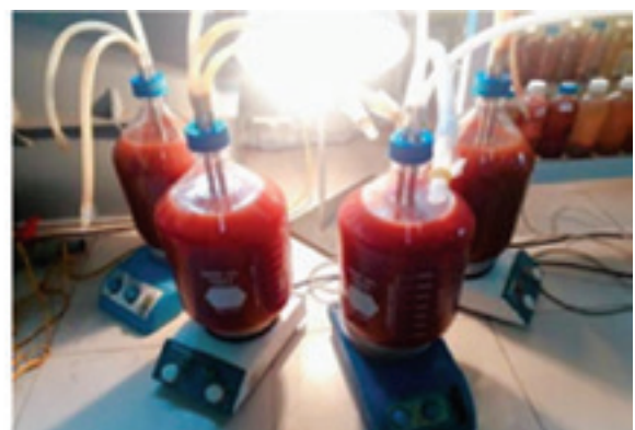
Hình 2B. Hình ảnh minh họa sản xuất sinh khối VKTQH trong bình duran 5 lít
