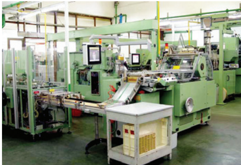
Dây chuyền sản xuất điếu Hauni Protos 90E tốc độ 10.000 điếu 1/phút
